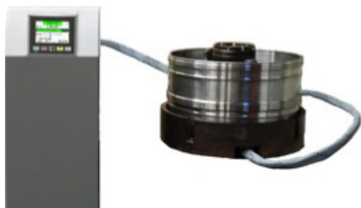
Frettage externe (chauffe sur l'extérieur de la pièce)
