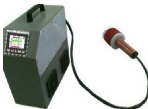
Frettage interne (chauffe sur l'intérieur de la pièce)
