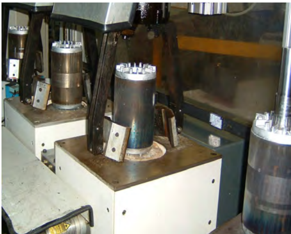
Chauffage par induction de rotors de moteurs électriques pour frettage d'axes
